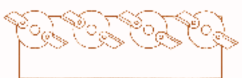
Lamiers rotatifs, plateaux à couteaux (mobiles ou rigides).
