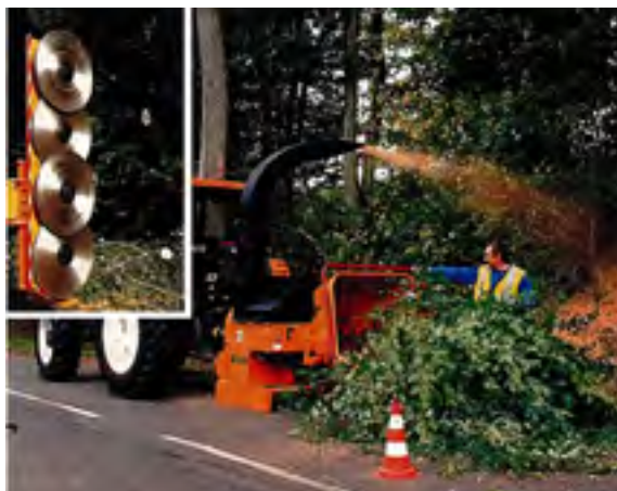
Taille au lamier de branches dont le diamètre est inférieur à 5 cm.
