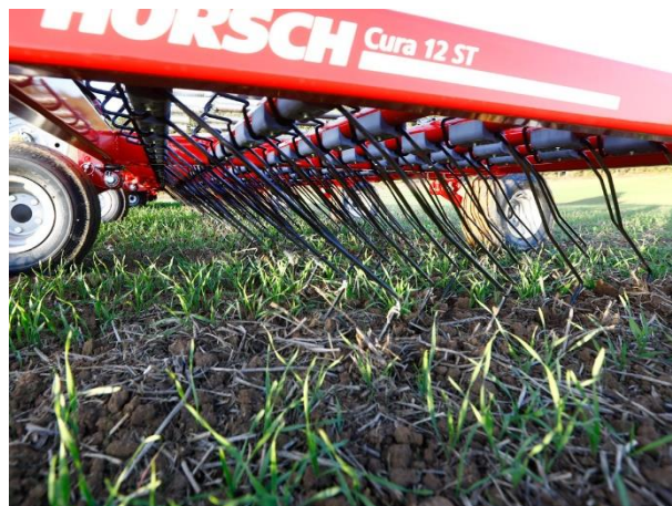
Figure 44 : Exemple de herse étrille Horsch, modèle ST12 d'après Horsh
