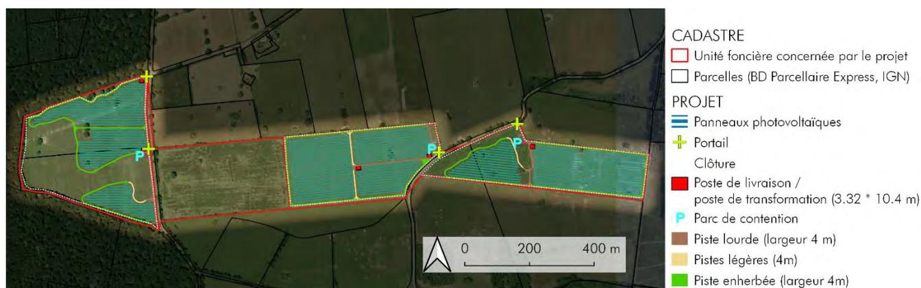
Figure 5 : plan de masse de la centrale agrivoltaïque de Mornay-sur-Allier (source : VALECO)
