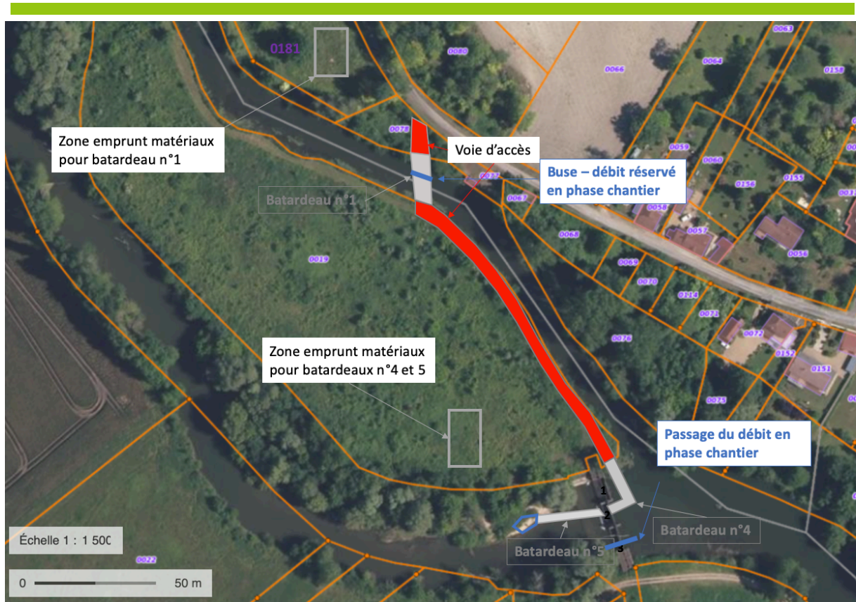
Figure 3 : Localisation des batardeaux n°4 et 5 et du bassin de décantation (phase 3).
