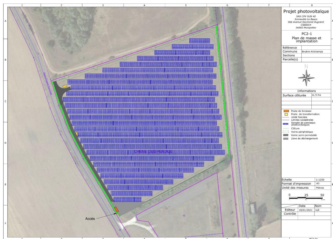
Variante 1 d'aménagement : maximisation de la puissance installée
