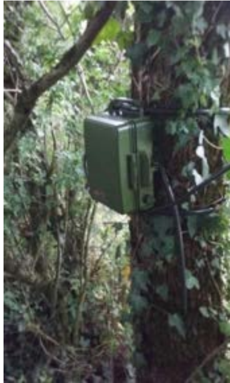
Figure 260 : Installation d'un enregistreur continu SM4BAT
