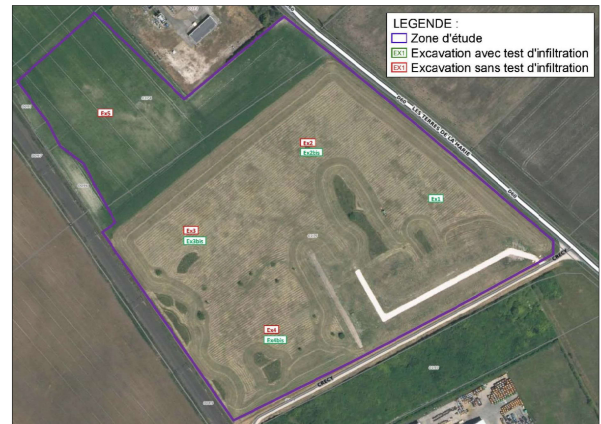
Figure 21: Localisation des sondages réalisés sur site (Source : SOND&EAU)
