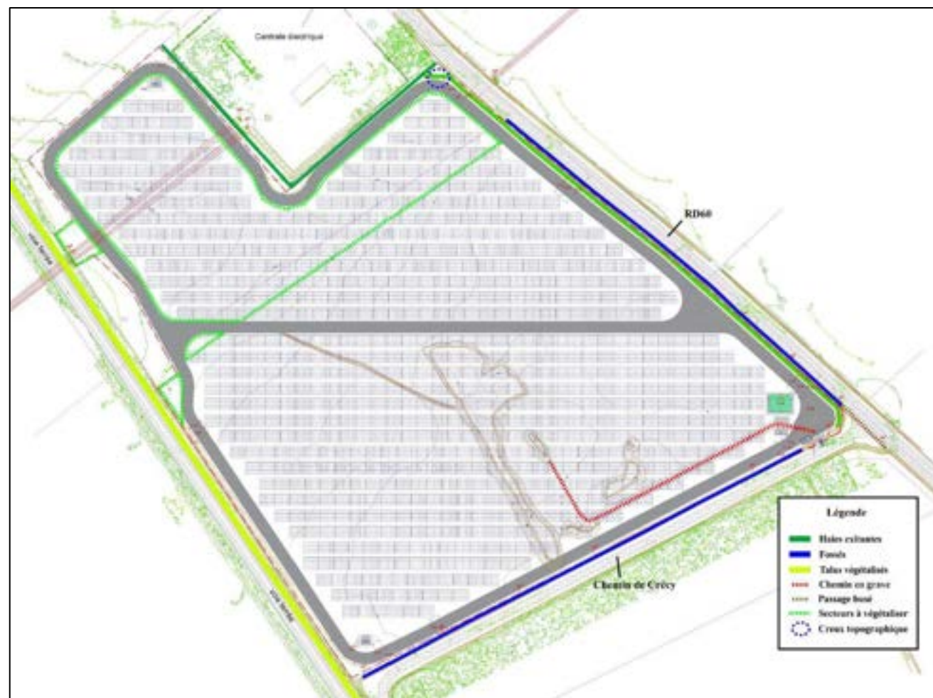
Figure 253 : Plan des propositions pour la gestion des eaux pluviales (Source : Etude hydrologique de SOND&EAU et ComiremScop)
