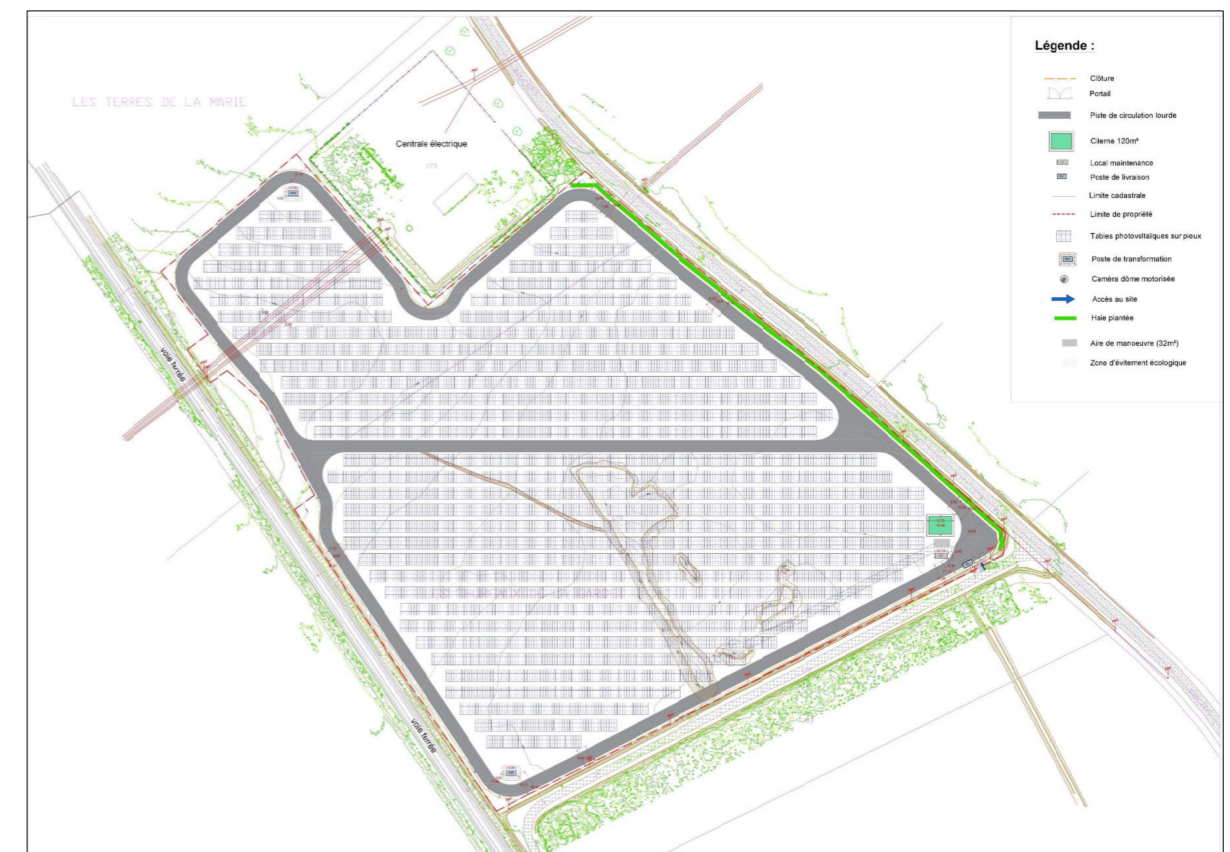
Figure 22 : Plan d'implantation prévisionnel dans sa version de septembre 2022 (Source : URBASOLAR)
