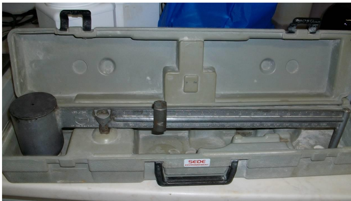
Figure 10: Mesure de la densité à l'aide d'une balance à boues.
