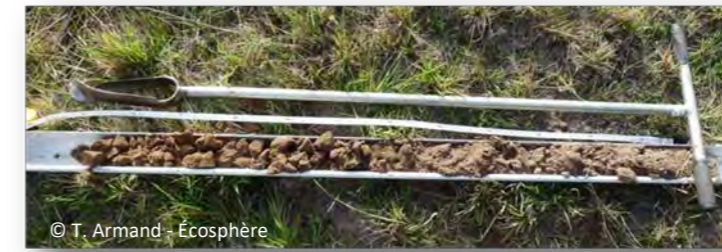
Sondage pédologique à la tarière manuelle
