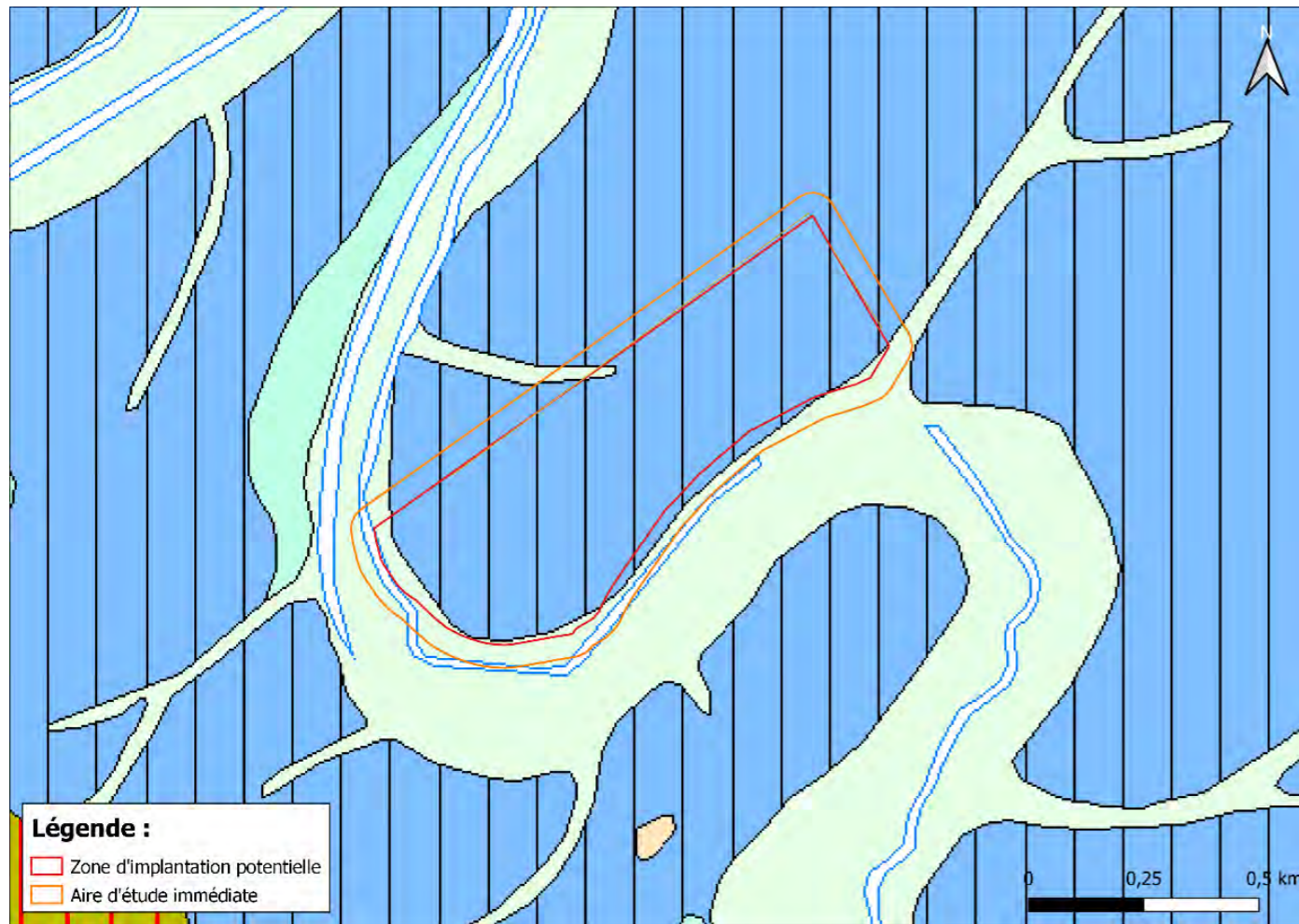
Carte géologique au 1/50000e de la zone étudiée (source : Infoterre) - Calcaires lités de l'Oxfordien supérieur (bleu rayé de noir) ; Alluvions anciennes des rivières et des colluvions argilo-sableuses des fonds de vallons (vert pâle) ; Lit mineur des cours d'eau (blanc cerclé de bleu).
